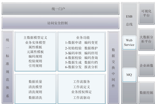
图1 企业信息集成的主数据管理平台框架 Fig.1 Framework of master data management platform for enterprise information integration
